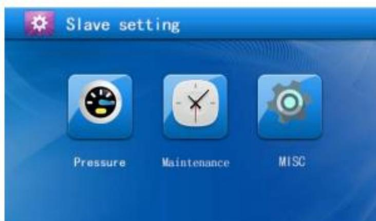
В окне Slave setting (Настройки ведомого устройства) доступны три опции: Pressure (Настройка давления), Maintenance (Настройка параметров технического обслуживания) и MISC (Другие настройки).
