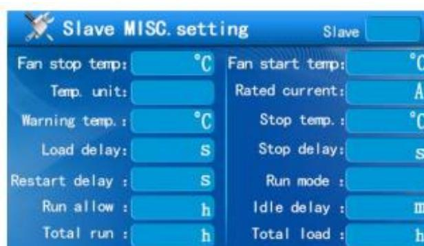
Slave (Ведомое устройство): устройство, для которого будет осуществляться настройка параметров.
