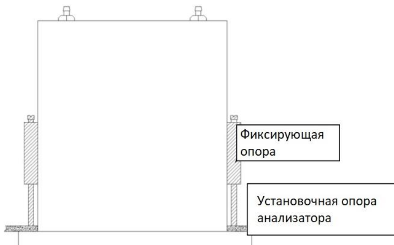
Рисунок 2. Установка анализатора и размер отверстия
